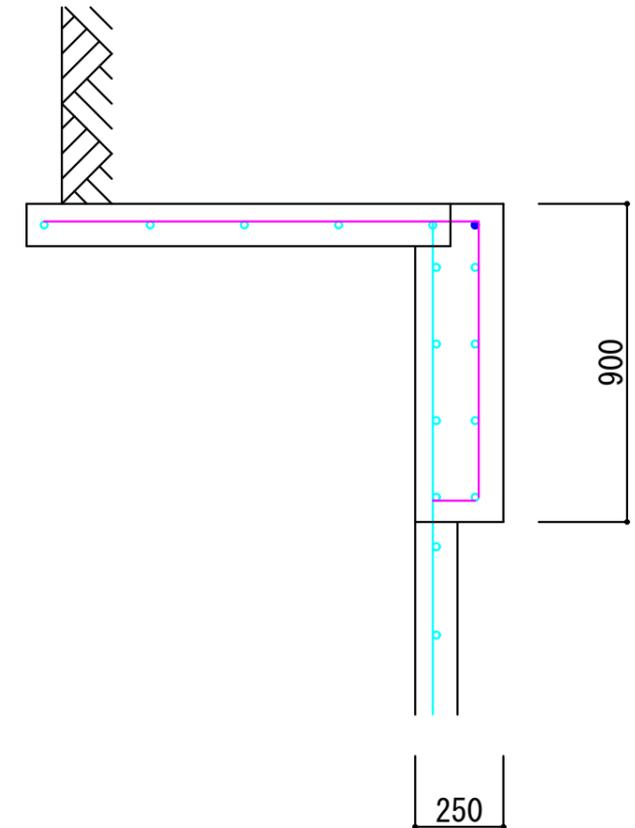
表面載荷 5kN/m<sup>2</sup> 天端1kN/m 地耐力40kN/m<sup>2</sup>
